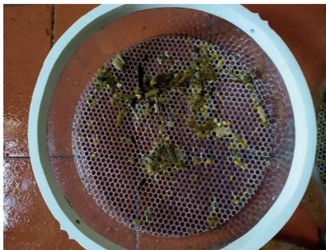
Рис. 4. На верхнем сите 4 % пробы... и в навозном проходе
